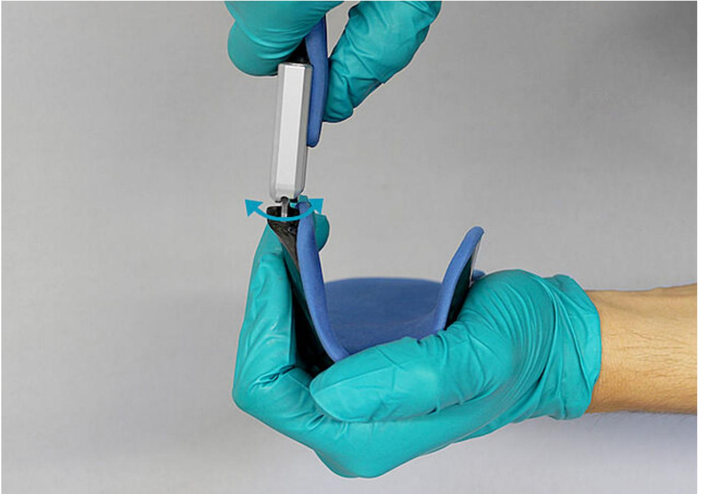
Fissare la scocca per parte inferiore della gamba e provare a muovere la scocca per piede in direzione pronazione-supinazione. Se si riscontra un gioco laterale, questo può essere dovuto a delle viti allentate e/o a dischetti di scorrimento usurati.
