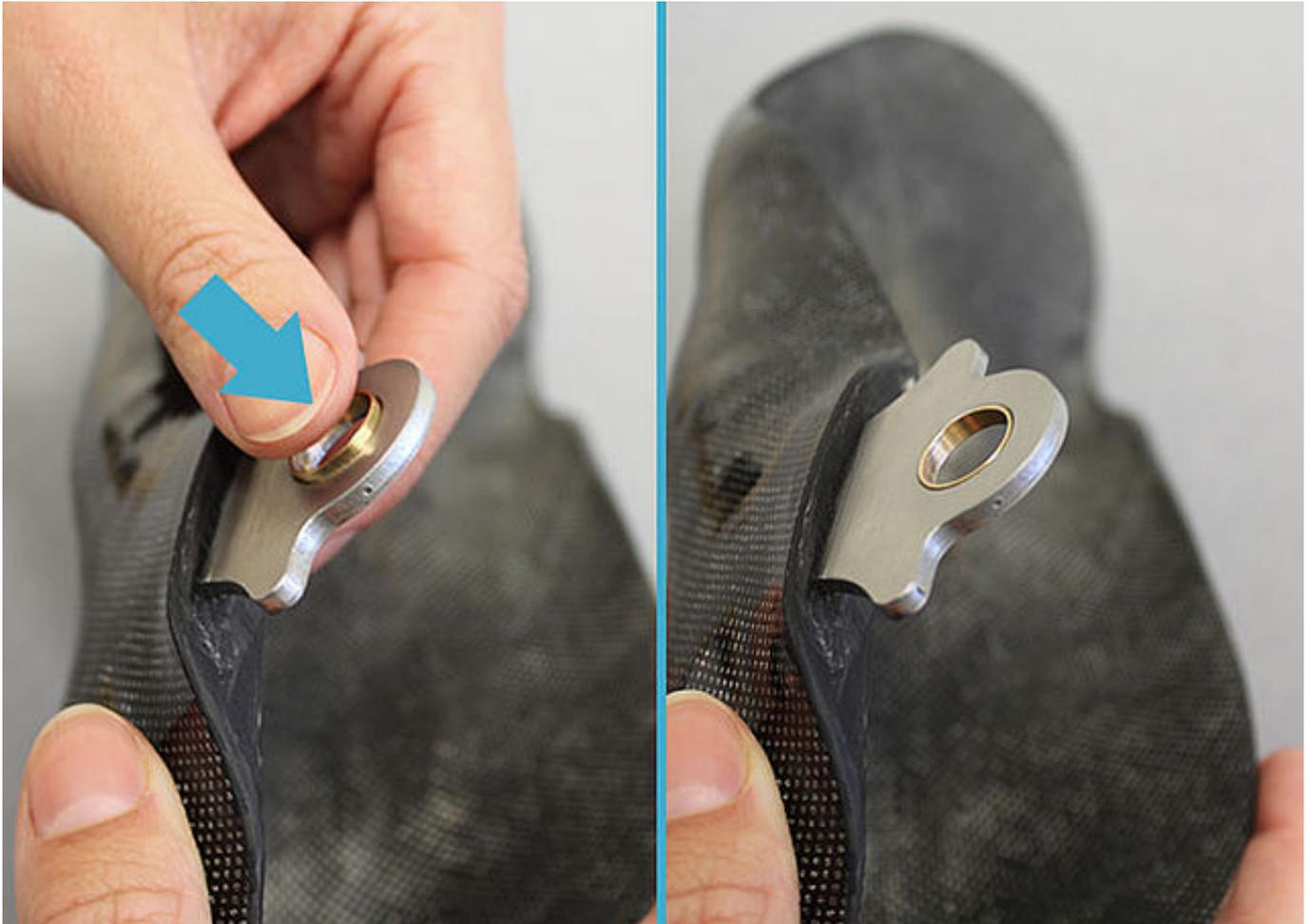
In presenza di usura, sostituire la boccola di slittamento con una nuova.
