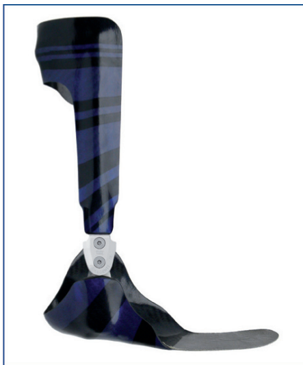
Abb. 10 Musterorthese: statische AFO mit dorsaler Schale und Neuro Vario Systemknöchelgelenk.
