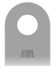
→ Sul collo, ogni staffa per piede modulare è dotata di linee di riferimento che permettono di leggere l'angolo dell'articolazione.
