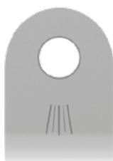
➔ Sul collo, ogni staffa per piede modulare è dotata di linee di riferimento che permettono di leggere l'angolo dell'articolazione.
